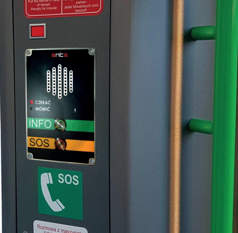
Beschallungsanlage und Gegensprechanlage
