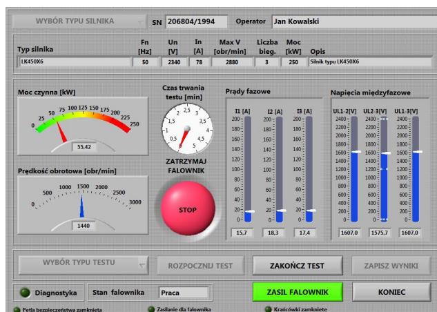
Panel kontrolny dla próby biegu jałowego silnika prądu zmiennego
